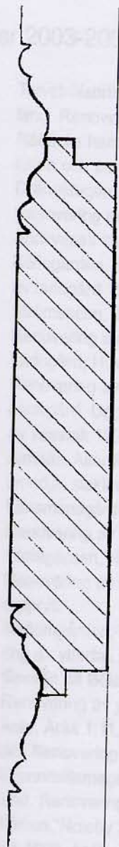
Panelbeklädnad på ytterdörrens utsida
